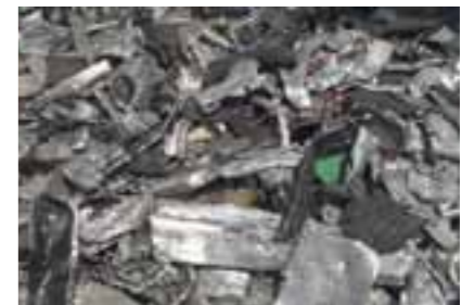
ALS-S型用ALS-S型设备回收的有色金属破碎品
