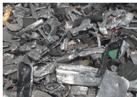
ALS-S型で回収された非鉄金属破碎品
